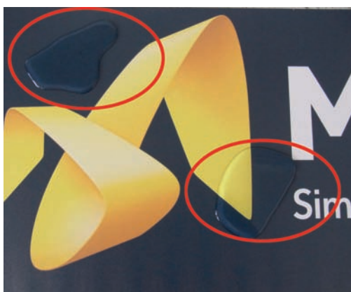
Abbildung 1: Druckmuster mit Wassereinwirkung 30 Minuten (rote Markierungen).
